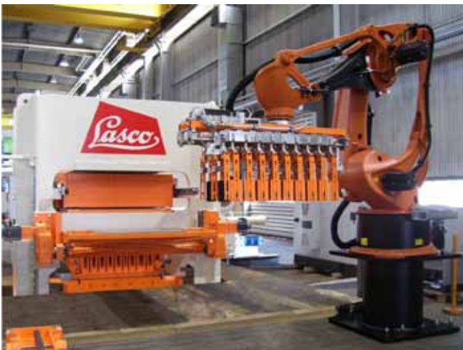
Die KSE 801 mit Handlingsroboter in Sonderausführung bei ihrer Montage im LASCO-Stammhaus in Coburg.
